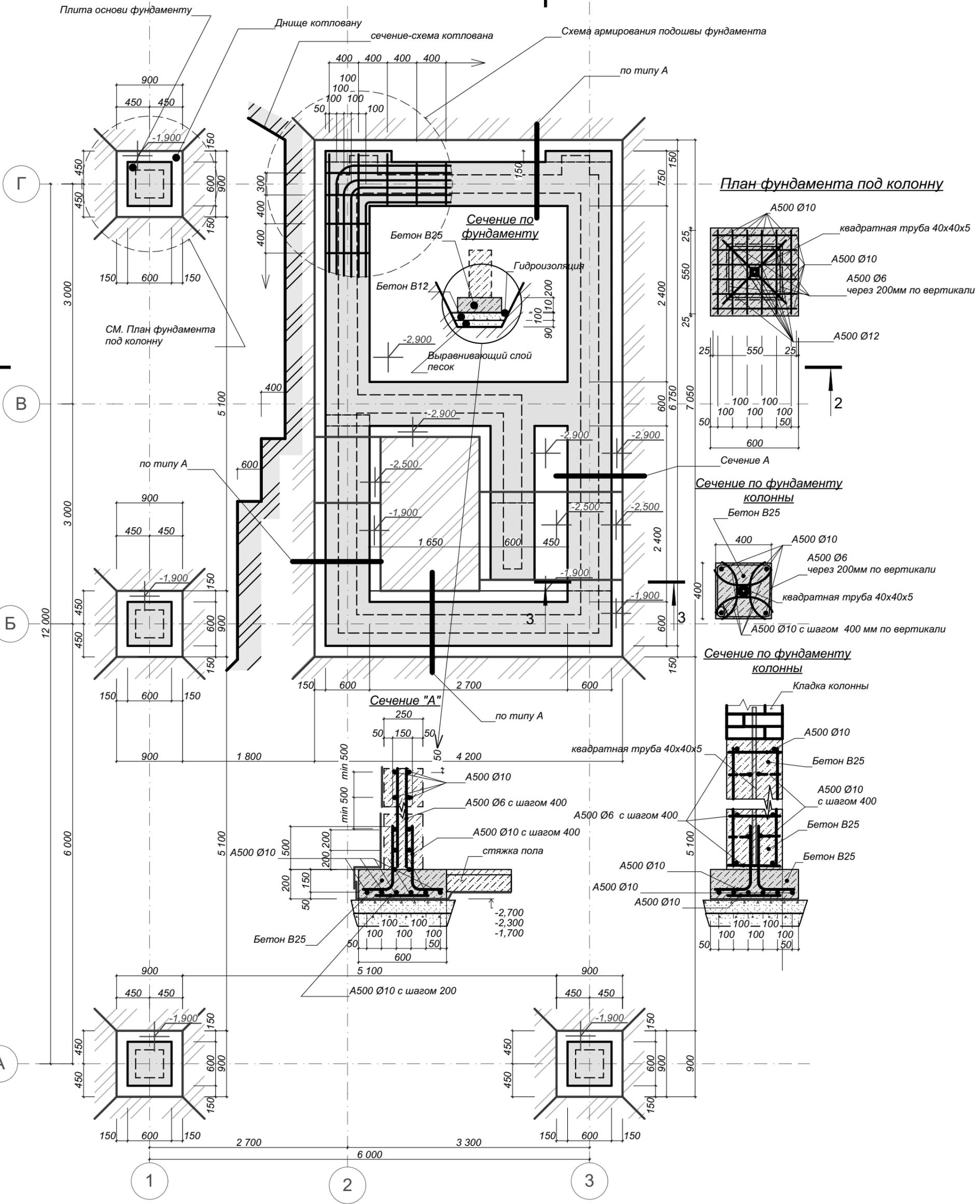
1. Вокруг фундаментов устроить оклеечную гидроизоляцию.
