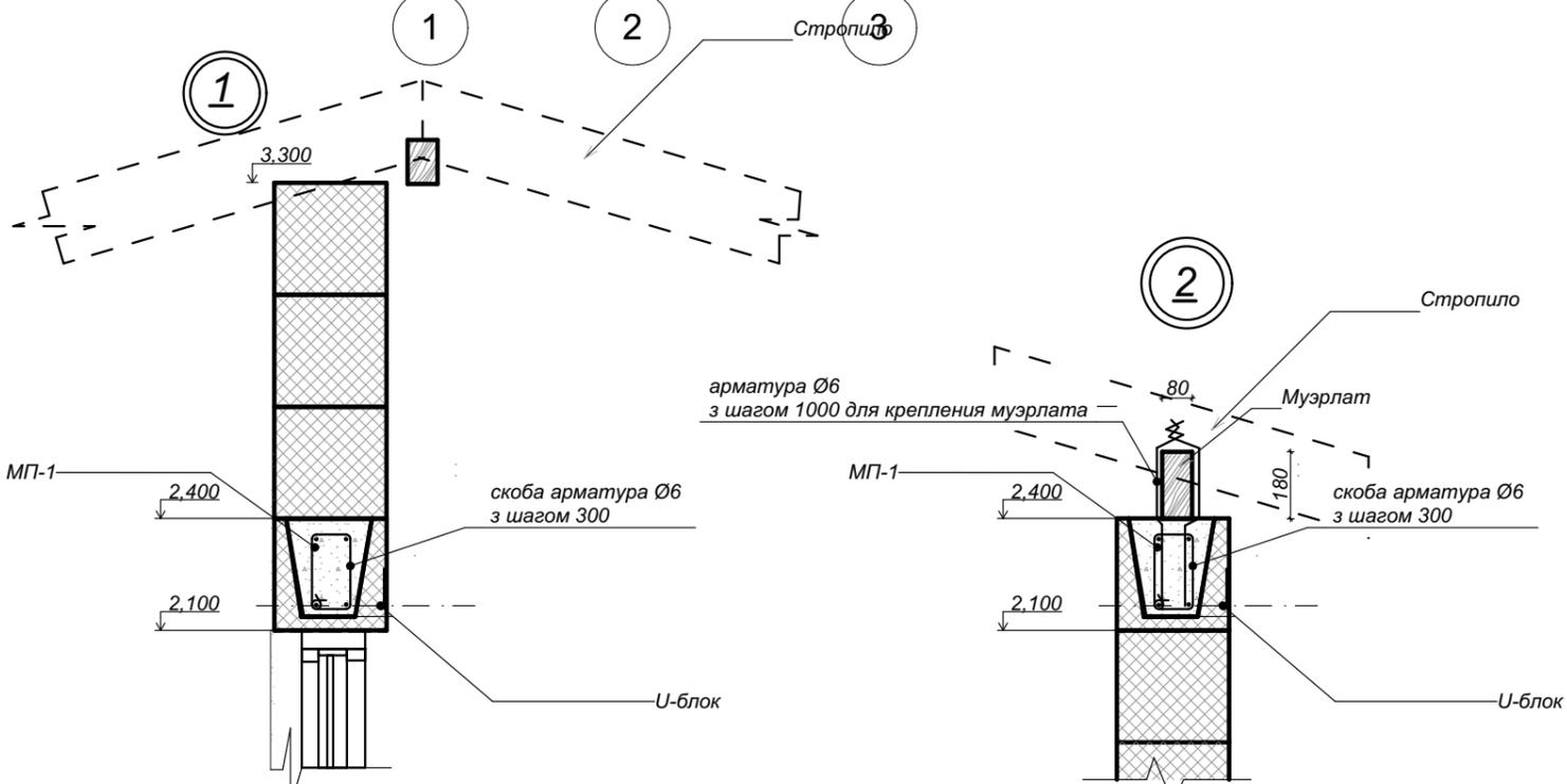
1. Можлива заміна поясу з "u" блоків на звичайний монолітний пояс на товщину стіни, з збереженням принципу армування.
