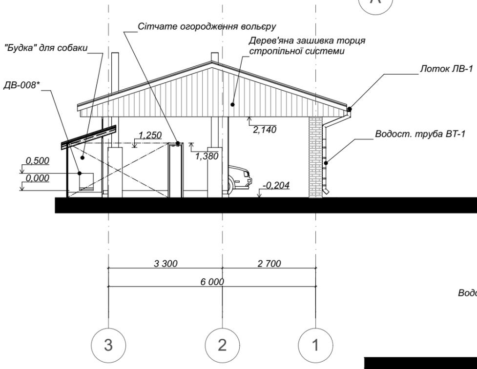
**Фасад в осях 3...1**
